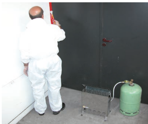
Rampe gaz en acier inoxydable avec électrode d'allumage, contrôle de flamme par thermocouple et contrôleur d'atmosphère
